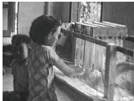
图13：一名华族妇女正在以徒手用粉状物打磨玻璃管
